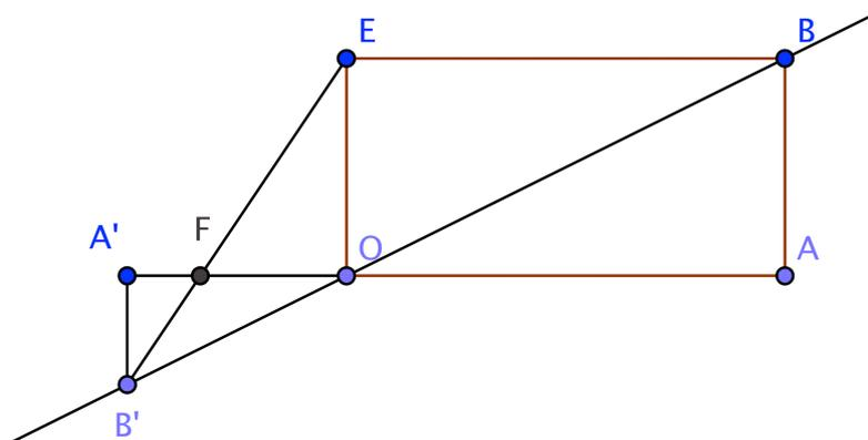
*Cette figure est utilisée en optique géométrique. Elle permet de construire l'image  $A'B'$  de l'objet  $AB$  par un dispositif optique (lentille,...) placé en  $O$  et de distance focale  $OF$ .*
